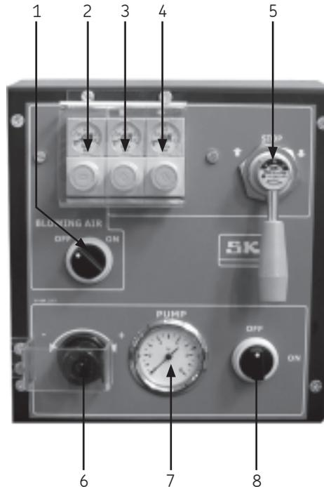
Bild 2 Bedienpult der Extruderpumpe PTEX
