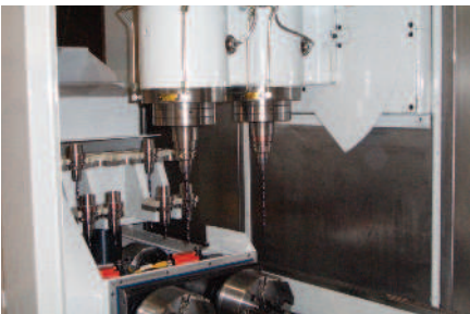
Doppelspindeln DigitalSuper-Aggregate mit zwei Aerosolgeneratoren zur Versorgung von Bearbeitungszentren mit Doppelspindeln
