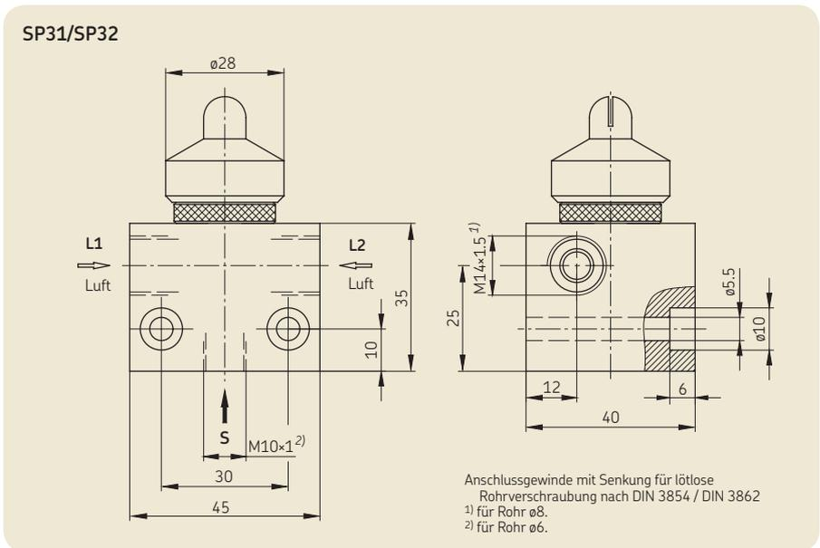
Die Sprühdüsen werden zum Besprühen von Oberflächen, z.B. Zahnflanken von großen Zahnrädern, mit Fett bis zur NLGI-Klasse 2 eingesetzt.
