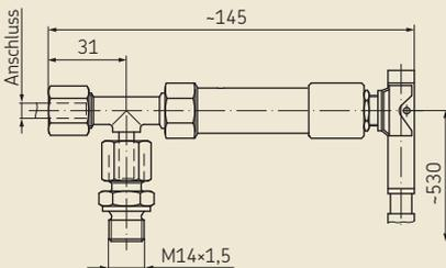
DBV mit Schmiernippel und SKF Steckverbinder
