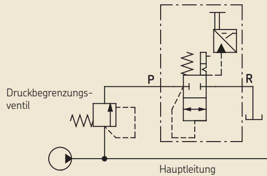
Funktion wie Beispiel 1, jedoch entfällt das Auswechseln einer Berstscheibe, da diese nicht zerstört wird und das Druckbegrenzungsventil bei Rückkehr zum eingestellten Druck wieder selbstständig schließt. Der Anzeigekolben muss wie bei Beispiel 1 von Hand zurückgeschoben werden.
