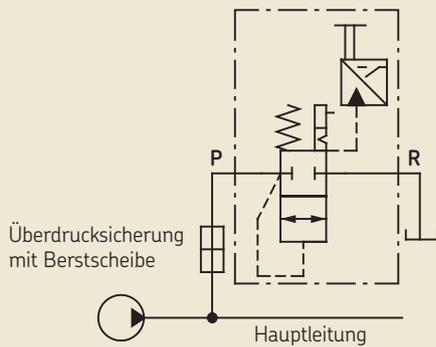
Druckanstieg (Störung) in der Anlage, über den vorbestimmten Wert hinaus, zerstört die Berstscheibe. Der Schmierstoff schiebt den Anzeigekolben aus, wodurch der Grenztaster betätigt wird. Dieser gibt ein elektrisches Signal für eine akustische oder optische Anzeige, er kann aber auch zum Abschalten der Maschine benutzt werden. Nach Beseitigung der Störung in der Anlage und Auswechseln der Berstscheibe muss der Anzeigekolben von Hand wieder eingeschoben werden.
