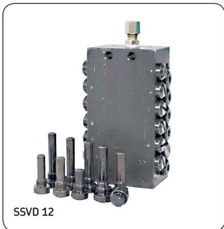
SSVD Verteiler sind je Auslasspaar einzeln dosierbar. Die Dosierung erfolgt innerhalb der Verteilerblöcke durch Dosierschrauben. Auch nach dem Einbau kann die Dosierung der Progressivverteiler leicht geändert werden.
