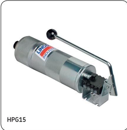
Diese preiswerten handbetätigten Einhubpumpen fördern eine genau bemessene Schmierstoffmenge, Fett oder Öl, je nach Modell. Die Fettschmierpumpen HP und HPG sind mit einer federbelasteten Folgeplatte und einem Kontrollstab zur Schmierstoffkontrolle ausgestattet. Die Ölschmierpumpe besitzt einen transparenten Kunststoffbehälter zur optischen Niveauüberwachung. In Verbindung mit SSV Verteilerblöcken können diese Einhubpumpen 1 bis 64 Schmierstellen mit Schmierstoff versorgen.
