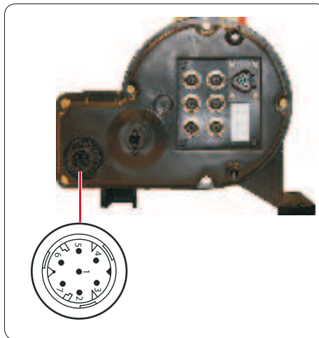
Spannungsversorgung durch Rundstecker siebenpolig
