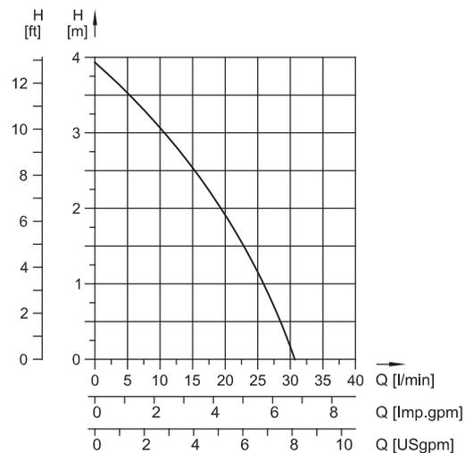
Daten gelten für Fördermedien mit Viskosität ~1 mm<sup>2</sup>/s bei Dichte ~1 kg/dm<sup>3</sup>
