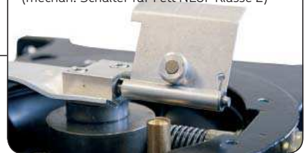
Füllstandsüberwachung (mechan. Schalter für Fett NLGI-Klasse 2)
