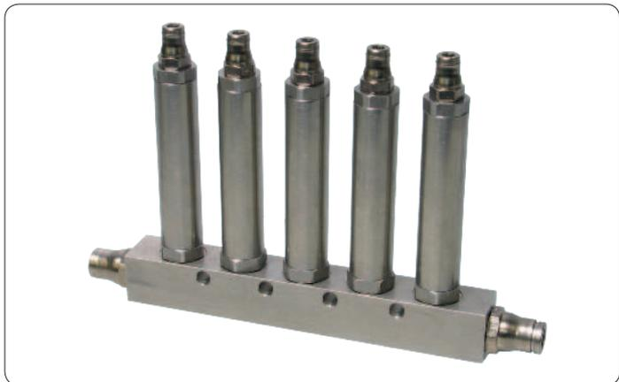
Die volumetrische Kolbenverteiler LS21.. dosieren und verteilen den Schmierstoff zu den **Schmierplatten für die Schmierung der Kettenoberfläche der Förderanlage.**
